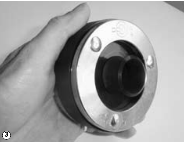
③ Danach das verbleibende Restgummi leicht anschneiden.
